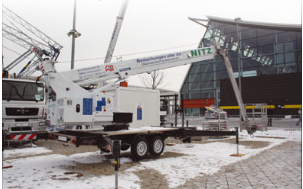
Der brandneue Anhängerkran von Böcker. Für die Masttechnik kombiniert das Unternehmen Metall und Aluminium
