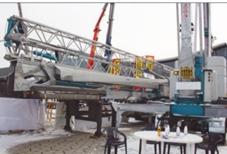
Für seine Untendreher setzt die Firma Stiefel auf befüllbare Ballastboxen. Sind diese leer, reduziert sich auch das Transportgewicht.
