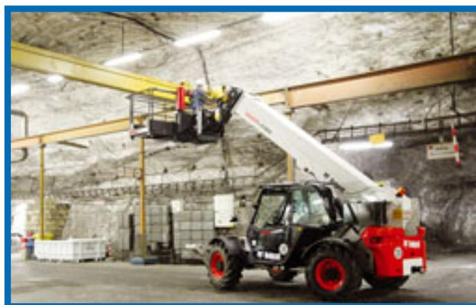
Mit einem Boomlader von Meis kontrolliert die K+S Kali GmbH in einem ihrer Salzbergwerke so genannte Tastlöcher. In einem Rhythmus von vier Wochen müssen 5.000 dieser Kontrollpunkte überprüft werden. Der „Boomlader“ besteht aus einem starren Bobcat-Teleskopklader mit angebaute Arbeitskorb, der bei angehobenem Ausleger aus dem Arbeitskorb verfahren werden kann, wodurch die Kontrollen schneller durchgeführt werden können.
