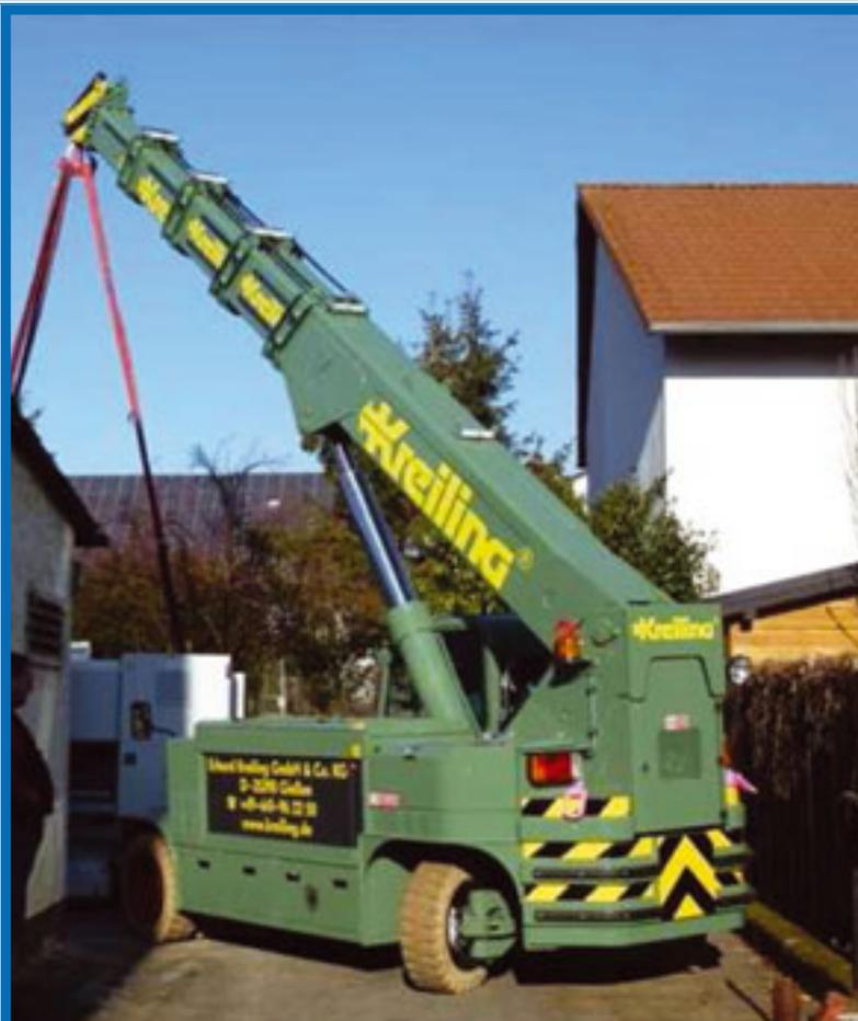
Der Schwerlast- und Krandienstleister Kreiling aus Gießen hat einen neuen Pick & Carry-Kran in Empfang genommen: einen Valla 120 EVO. Er verfügt über einen fünfteiligen Teleskopausleger, hebt bis zu 1,7 Tonnen bei maximal 13,5 Meter Hakenhöhe. Bei horizontalem Ausleger liegt die Ausladung maximal bei 9,5 Metern; dann hebt der Kran noch eine ganze Tonne.
