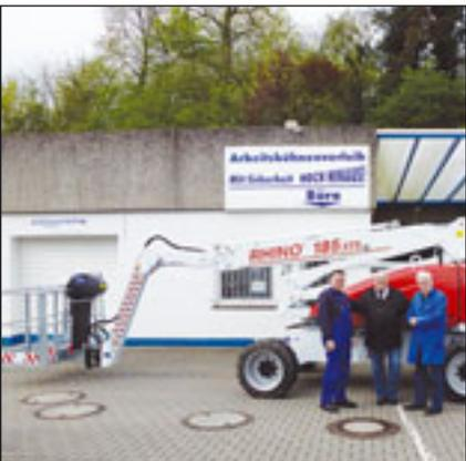
Der erste Rhino 185XTS in Deutschland ist an seinen neuen Eigner, den Arbeitsbühnenverleih Winzer, übergeben worden. Die selbstfahrende Gelenkteleskoparbeitsbühne mit 18,5 Meter Arbeitshöhe und 11,7 Meter seitlicher Reichweite wird vom Firmensitz Leverkusen aus eingesetzt werden. Das Modell wurde auf der APEX 2011 vorgestellt. Bei der Übergabe anwesend: Harald (l.) und Günter (r.) Winzer umrahmen Franz Heiland von Hematec.
