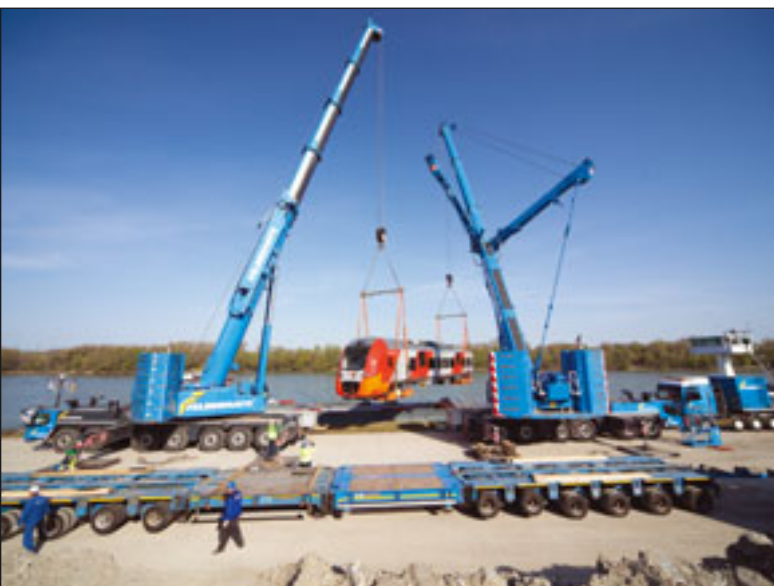
Felbermayrs Giganten arbeiten zusammen beim Umschlagen eines Waggons
