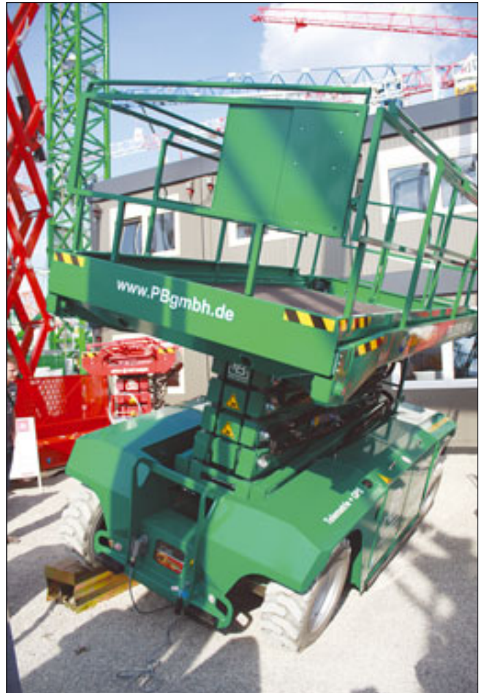
Einen Höhenausgleich von bis zu 38 Zentimeter erreichen die Scherenbühnen von PB
