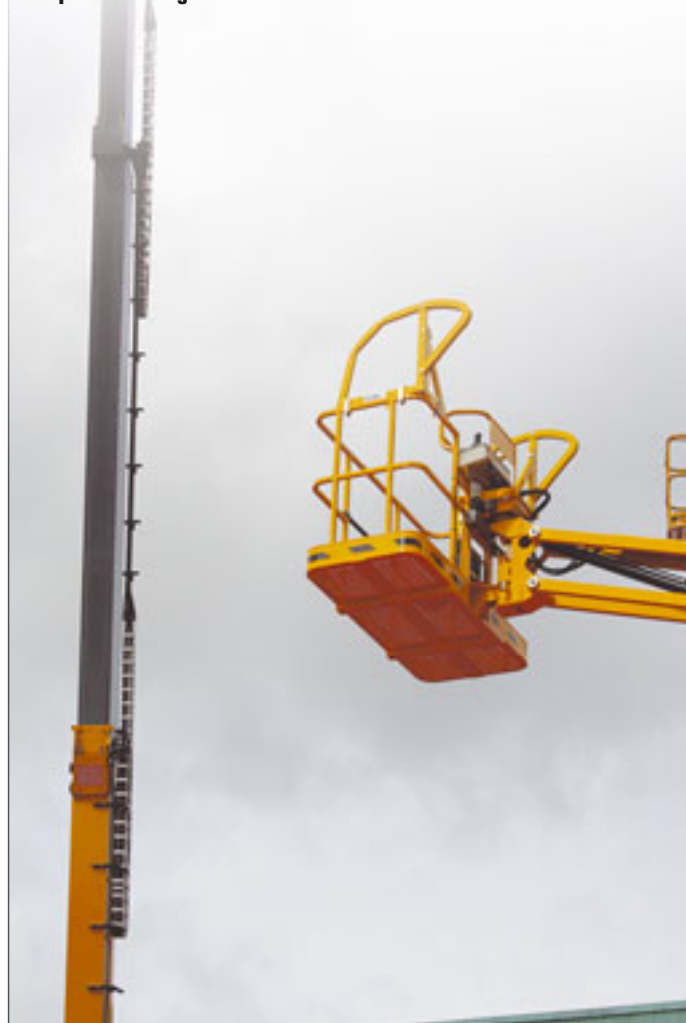
Haulotte bietet einen Aufbau auf den Korb als Sicherheitsgeländer und Stoßschutz an
