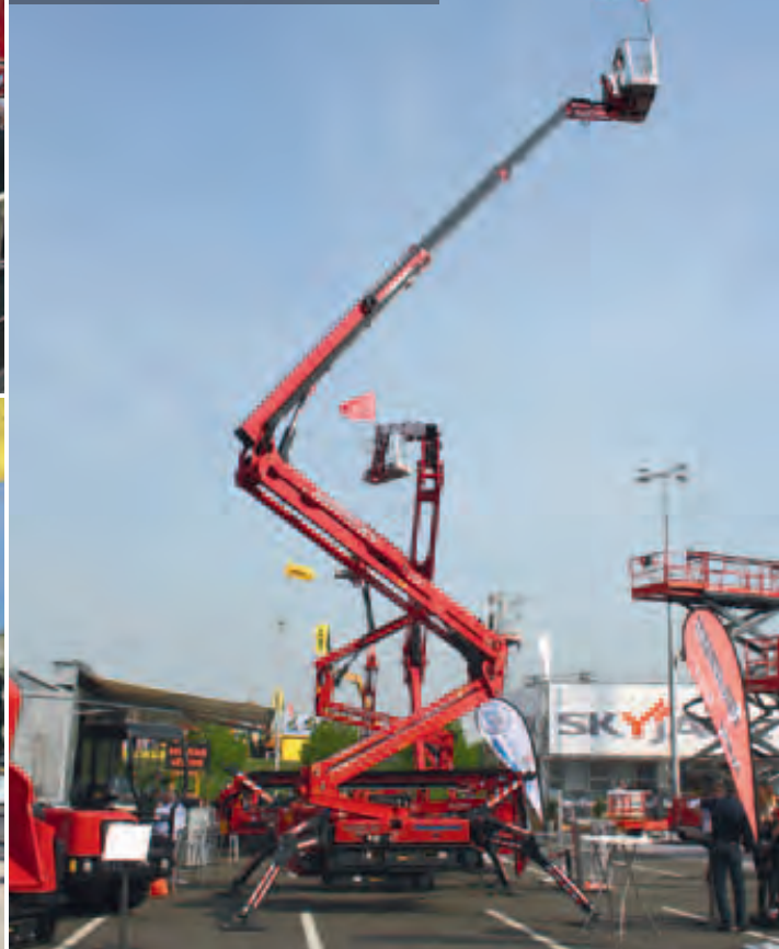
Die neue Lightlift 26.14 von Hinowa erklimmt 26 Meter Arbeitshöhe
