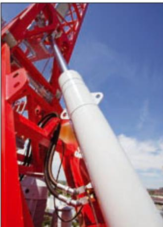
Der Wippzylinder mit Loadensing-Steuerung
