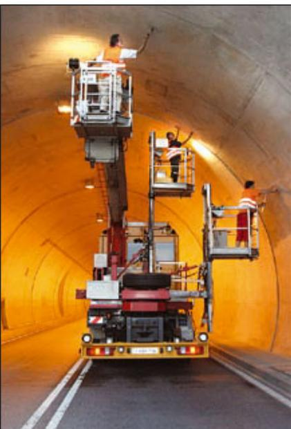
*Wemo-Tec setzt für Tunnelinspektionen auf das Dreifach-Prinzip. Die TUA 1600 T erlaubt dank dreier unabhängiger Körbe eine zügige Inspektion*
