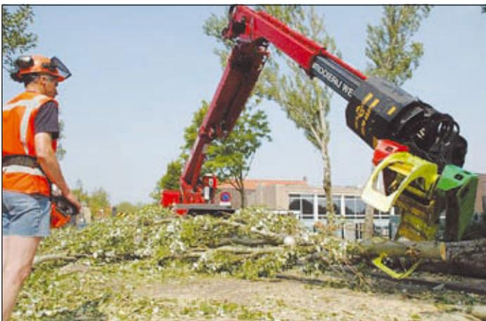
Wejtmans Spezialkran zum Baumfällen von MKG basiert auf dem HMK 901T
