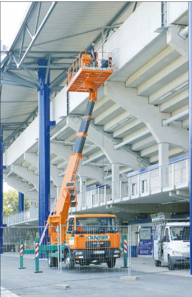
Eine Spezial-LKW-Bühne der Marke Aichi von Cramer Arbeitsbühnen mit breitem Korb und hoher Traglast kam bei der Abschlussprüfung des Wedau zum Einsatz
