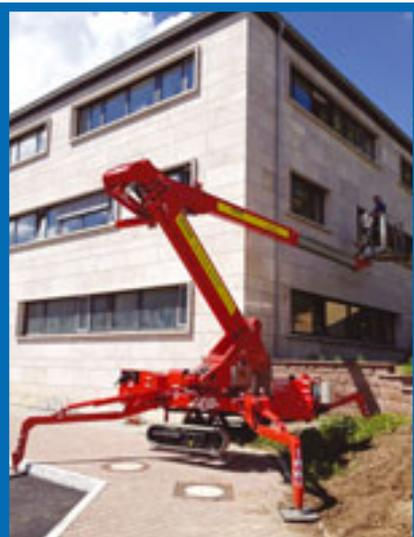
Fenster putzen ist an sich etwas Alltägliches, auch im Schwarzwald. In Unterkirnach bestand die Sorge, dass die neu verlegten Pflastersteine des Gehwegs bei einem Einsatz einer Arbeitsbühne in Mitleidschaft gezogen werden. Die Lösung kam auf Ketten. Mittels einer Raupenarbeitsbühne von Schwenk konnten die Arbeiten ausgeführt werden. Das Gerät, ein Teupen Leo 23GT, hatte die „sanften“ Ketten um und die notwendige Reichweite von 11,20 Meter.
