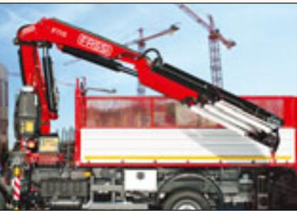
Mit dem F110B stellt Fassi nicht nur einen neuen Kran vor, sondern läutet einen Wechsel seiner Typenbezeichnungen ein. Durch den Einsatz hochwertiger Feinkornstähle ist der neue Fassi F 110B-Kran 300 Kilogramm leichter als sein Vorgänger. Das entspricht einer Reduzierung des Eigengewichtes um rund 20 Prozent.
