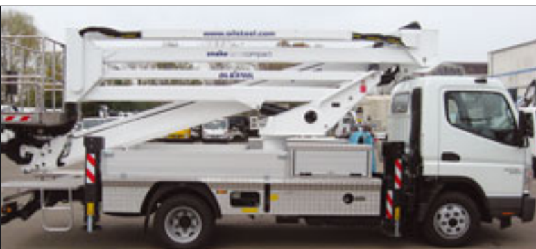
Mit der Snake 2815 compact bringt Oil&Steel ein 28 Meter-Gerät mit 15 Metern Reichweite auf den Markt
