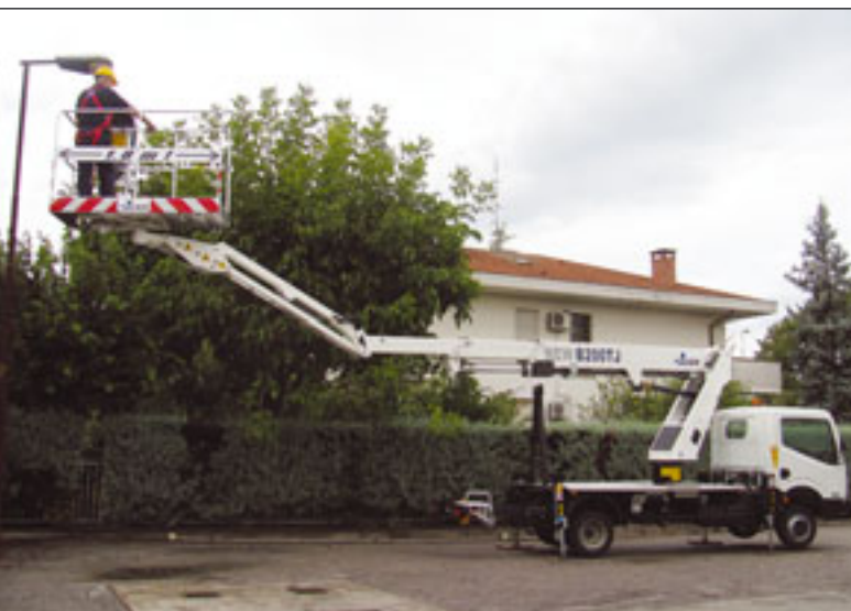
Drehbarer Korb und Korbarm erhöhen die Zugangsmöglichkeiten der neuen GSR B200J
