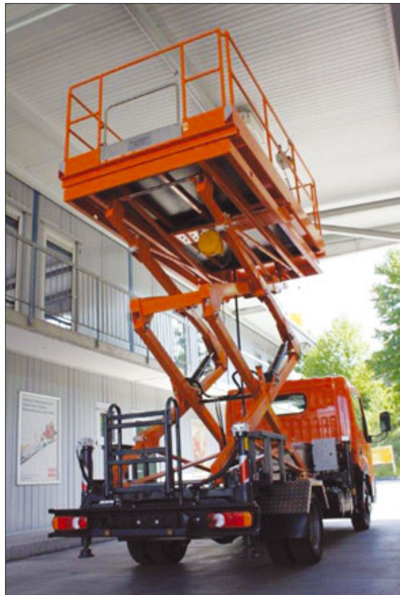
Ein eigenes LKW-Konzept hat Maveltech entwickelt. Hier werden Scherenbühnen als Aufbau genutzt.
