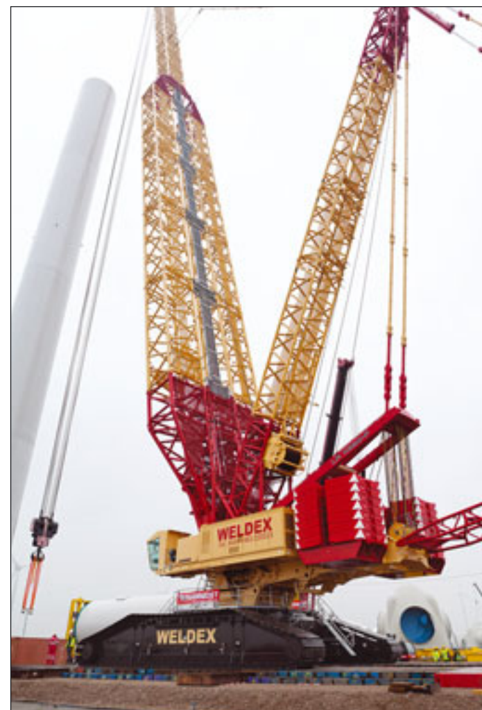
P wie Premiere: Liebherr's P-Ausleger am LR11350 bei seinem Ersteintritt in Eemshaven
