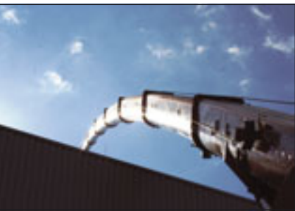
Der Ausleger des ATF 220G-5 von Tadano Faun weist eine hohe Elastizität auf
