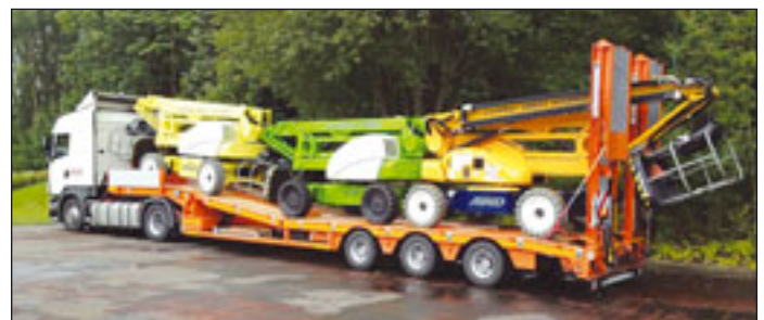
Die kompakten Geräte von Niftylift: Gleich drei HR21 können auf einem Tieflader transportiert werden
