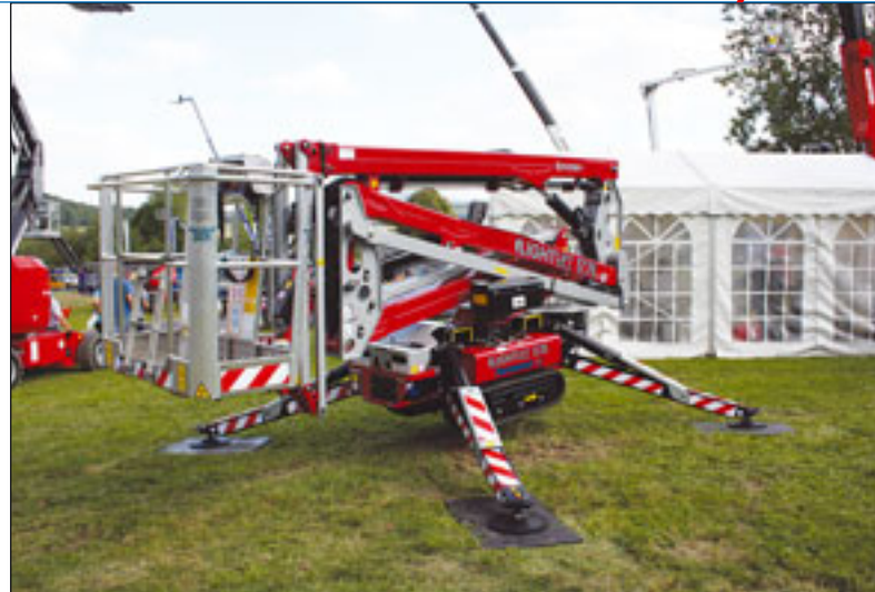
Hinowas neue LightLift 17.75 Performance: Das Gerät bietet bei voller Korblast von 230 Kilogramm eine Reichweite von 7,5 Meter
