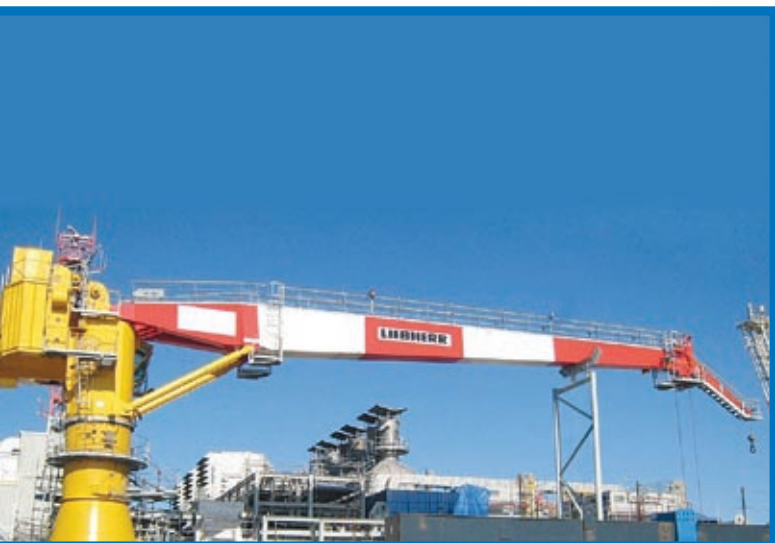
Für das Cygnus-Gasprojekt in der südlichen Nordsee liefert Liebherr Nenzing vier Offshore-Krane vom Typ RL2650-25 D EX Litronic an das Joint-Venture GDF Suez E&P UK. Der Kran hat eine maximale Traglast von 60 Tonnen sowie eine maximale Ausladung von 54 Metern. Das Cygnus-Gasfeld gilt als das größte Gasvorkommen, das in den letzten 25 Jahren in der südlichen Nordsee entdeckt worden ist.
