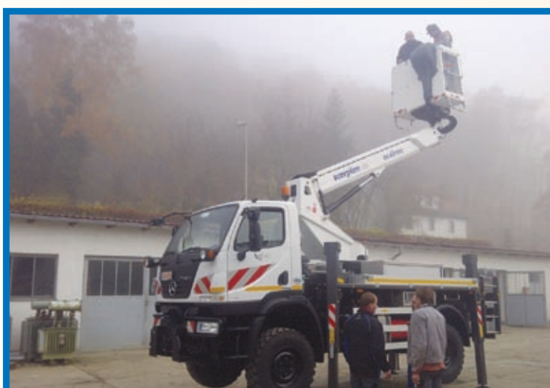
Eine Oil&Steel Scorpion 15 E in Geländeausführung, aufgebaut auf einem Unimog, hat das Elektrizitätswerk Wörth/Donau in Empfang genommen. Geschäftsführer Rupert Heider sieht eine Vielzahl von Einsatzmöglichkeiten für sein Unimog-Unikat. Das Abstützen innerhalb der Fahrzeugkontur mit sehr langem Stützenhub ermöglicht sowohl das Arbeiten im laufenden Straßenverkehr als auch das Arbeiten im Gelände.
