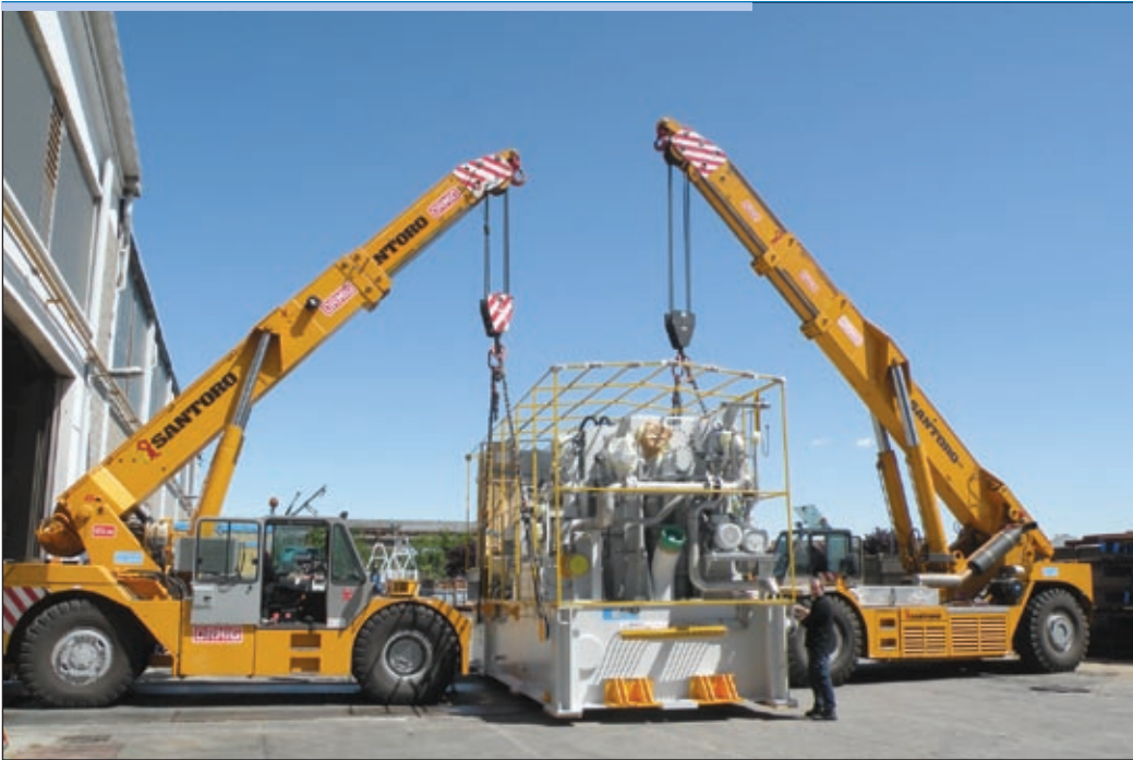
Zwei Pick&Carry-Krane von Ormig im Tandemeinsatz
