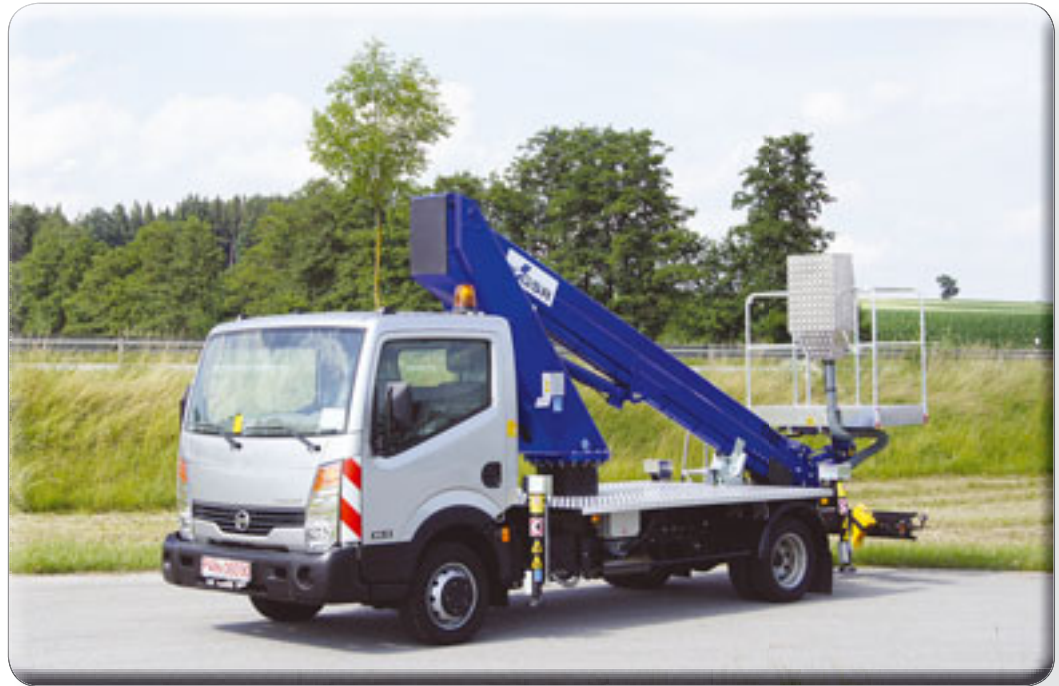
Die GSR E179T Compact mit Senkrechtabstützung
