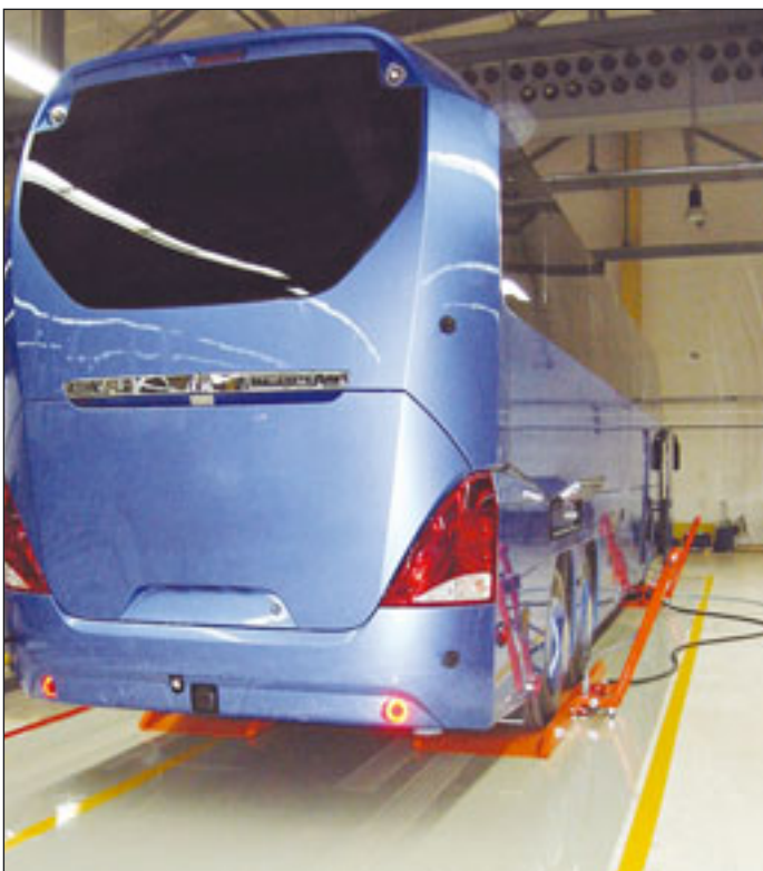
Bus auf Luftkissentransporter: Solving-Technik bei Neoplan
