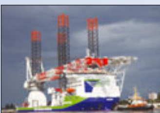
Liebherr's ‚Crane Around the Leg‘ CAL 64000-1500 auf der ‚Innovation‘
