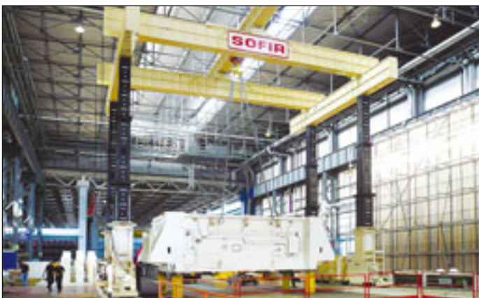
„Power Tower“ Modell 34 PT 5400 LT der Firma Sofir bei der Montage von Transferpressen in der Automobilindustrie
