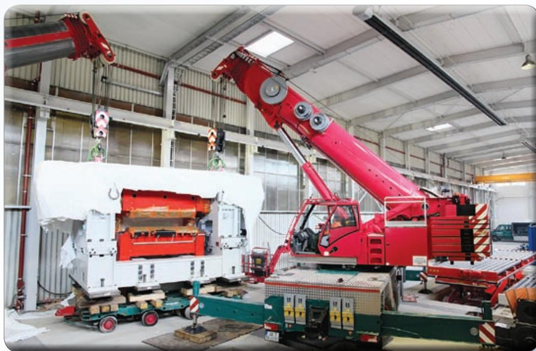
Feinfühlig positionieren die beiden „Indoor-Spezialisten“ eine Exzenter-Schwingschere
