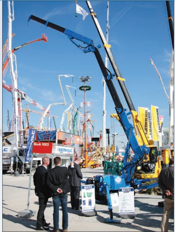
Ein Knick an der richtigen Stelle: Der neue Maeda Minikran MK 1033 C bietet so eine „Up & Over“-Funktion
