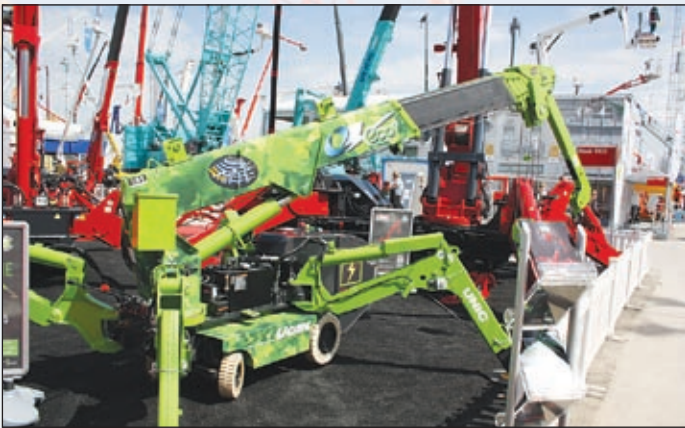
In grün gehalten ist dieser Minikran von Unic. Der batteriebetriebene Kran kann bis zu drei Stunden im Dauerbetrieb laufen, bevor die Batterien wieder aufgeladen werden müssen.
