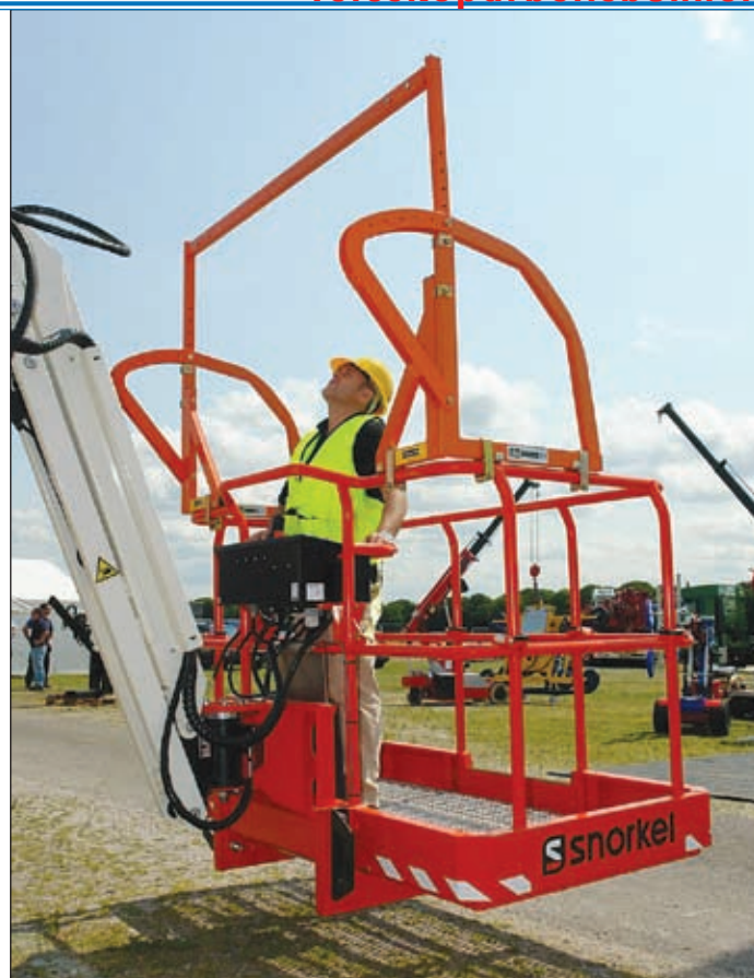
Die sogenannte ‚Sanctuary Zone‘ bietet dem Bediener Schutz auf Snorkels A46JRT
