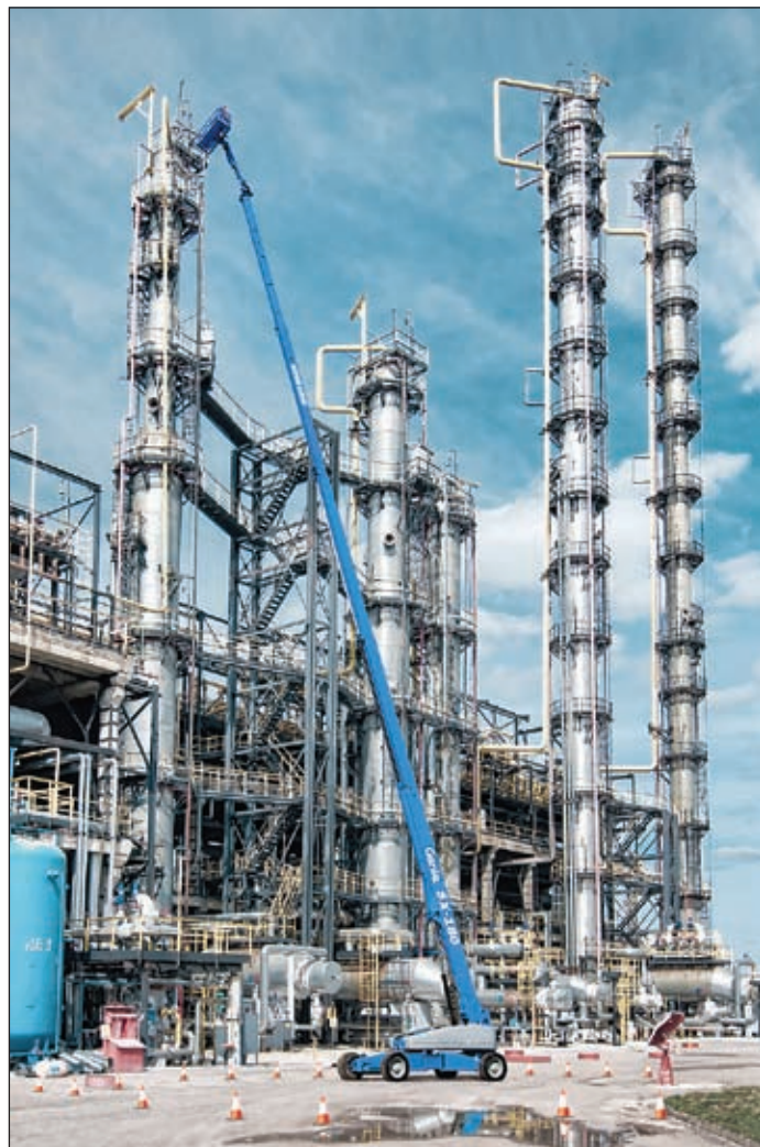
Der Superboom SX-180 fährt bis auf 55 Meter rauf, macht 57 Meter Arbeitshöhe
