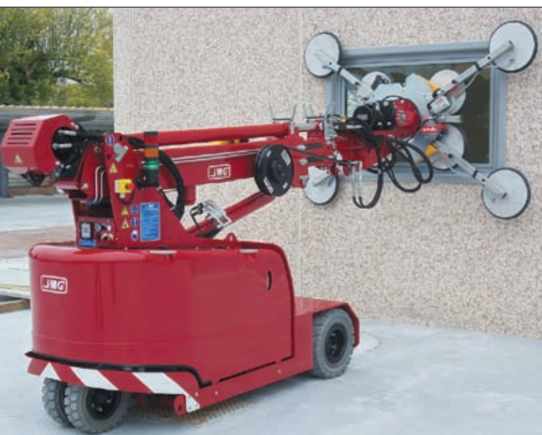
JMG-Kran mit Autec-Funkfernsteuerung
