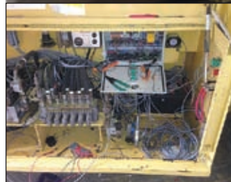
Das Salzwasser hat auch die Elektronik kräftig angegriffen
