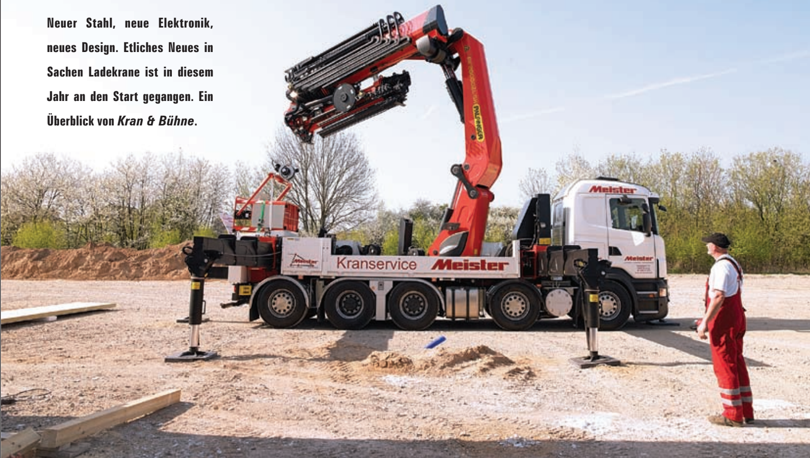
Mit dem 200002 hat Palfinger einen Großkran mit 40 Tonnen Tragkraft auf den Markt gebracht
