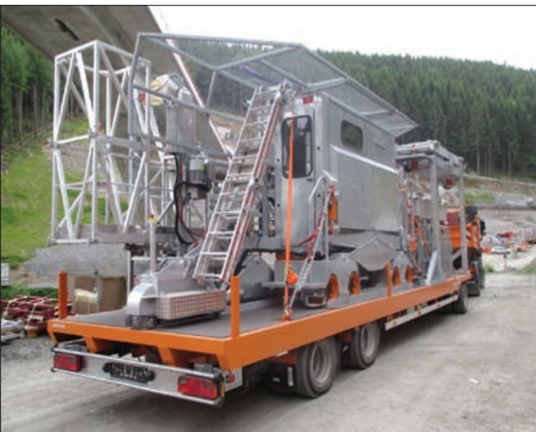
Ein eigens auf den Transport von Brückenuntersichtsgeräte spezialisierten Anhänger hat Moog entwickelt
