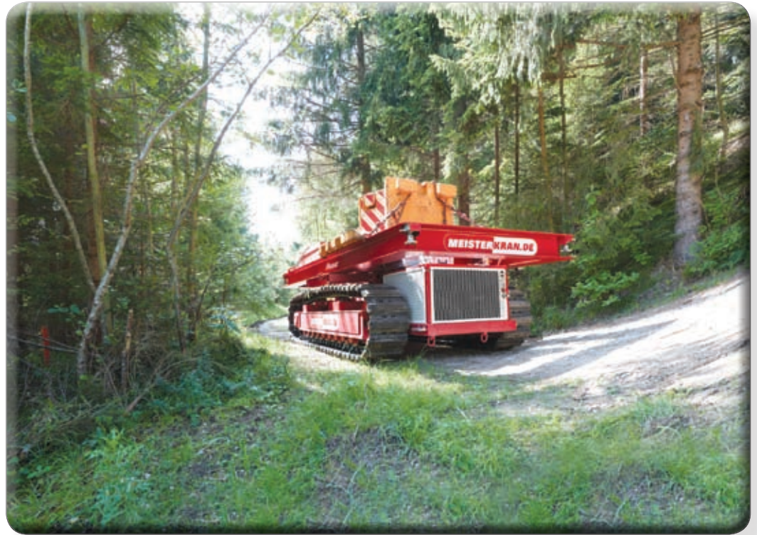
Die Schwerlasttransportraupe TC 50 bringt den Ballast für den AT-Kran an den Einsatzort
