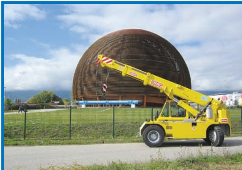
Gern ins CERN: Ein Ormig-Kran mit 16 Tonnen Tragkraft und speziellem Partikelfilter durfte die heiligen Hallen der Forscher im schweizerischen Genf betreten, um Wartungs- und Umsetzarbeiten durchzuführen. Nur der Fotoapparat muss draußen bleiben.
