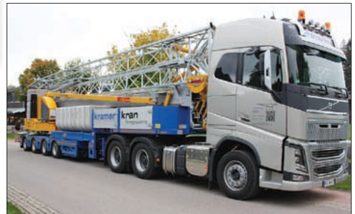
Die Untendreher von Kramer Kran werden per Tieflader transportiert und aufgestellt
