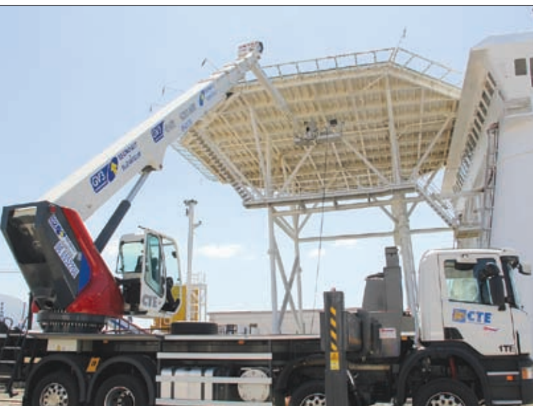
Die B-Lift 620HR von CTE sitzt auf einem 18-Tonnen-Fahrgestell
