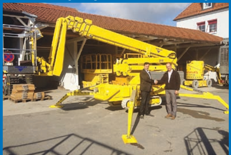
Ommes erste 2500 RXBDJ geht an die Firma Hochmuth aus Augsburg. Die kompakte, in Transportstellung nur 1,10 Meter breite Kettenbühne setzt auf Gelenkteleskoptechnik und bietet sowohl einen beweglichen Korbarm als auch eine Aufstellautomatik. Daneben haben Stefan Drischberger, den Geschäftsführer der Firma Hochmuth, die insgesamt „guten Parameter“ der Bühne überzeugt.
