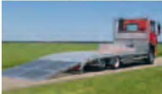
Veldhuizen Wagenbouw aus den Niederlanden zeigt einen Auffahr-Tieflader mit viel Nutzlast: Der CF 26-79 hat eine Ladeflächenhöhe von 88 Zentimetern, einen Auffahrwinkel von acht Grad und ist erhältlich mit Automatikgetriebe sowie einem Motor mit wahlweise 310 oder 400 PS. Ebenso wird ein Minisattelanhänger gezeigt.
