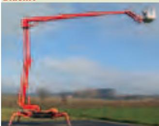
Die Raupenarbeitsbühnen aus Italien werden in Deutschland über die Firma Rothlehner angeboten. Diesmal an Bord: die überarbeitete Bluelift R220C mit erhöhter Korblast und geänderten Stützen.
