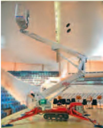
Palazzani Industrie zeigt zwei Arbeitsbühnen aus der Ragno-Serie: eine TZX 225/C mit über 22 Metern Arbeitshöhe und zehn Metern Reichweite sowie 2,5-Tonnen Eigengewicht und eine 32-Meter-Maschine vom Typ XTJ 32/C mit Raupenkette und mit Bi-Energy-Antrieb.
