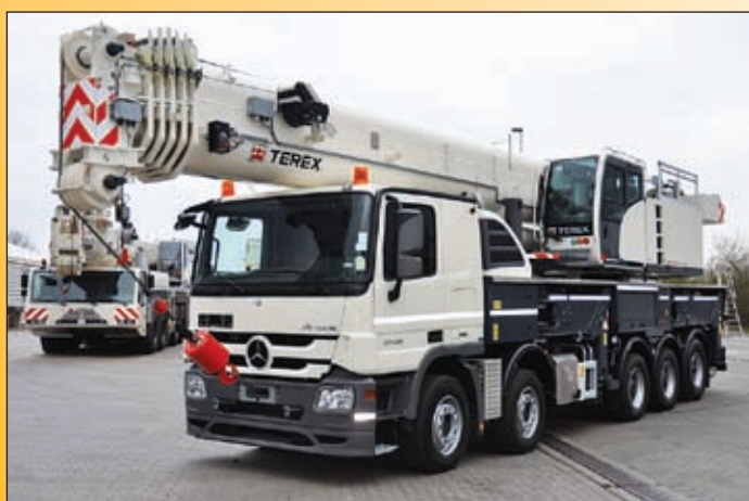
Unterwagen und Oberwagen vereint: der Roadmaster 5300
