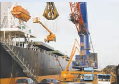
Der erste Boomlift wird vom Hafemobilkran angehoben
