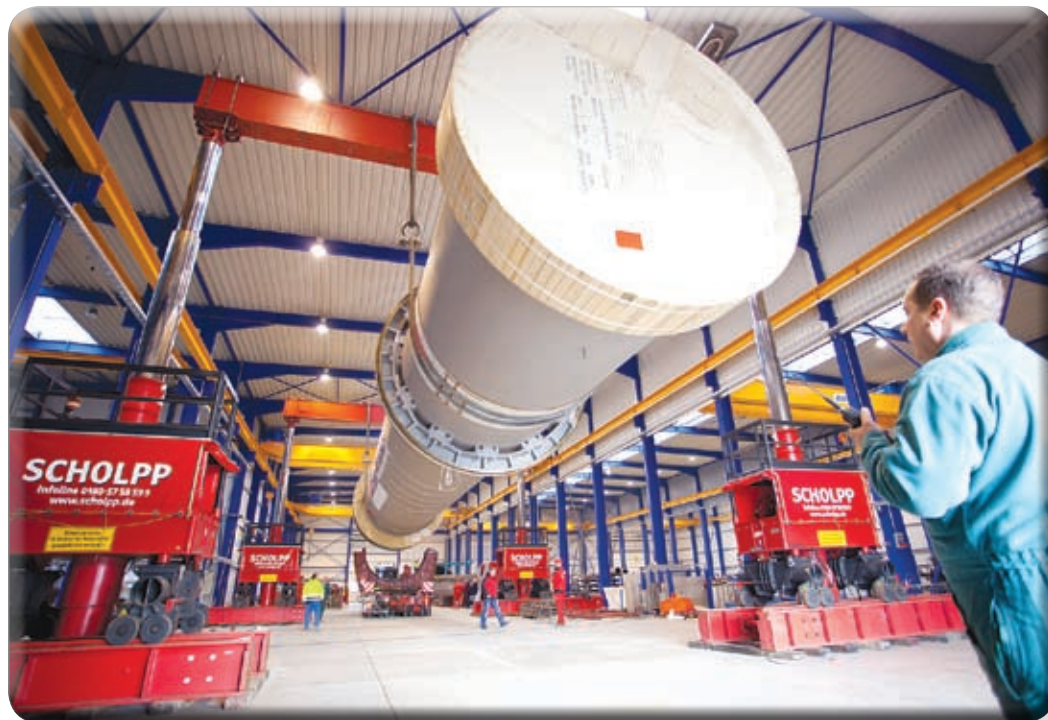
Greiners Hubgerüst GHS 3 hilft beim Verladen des 180 Tonnen schweren Kalzinators
