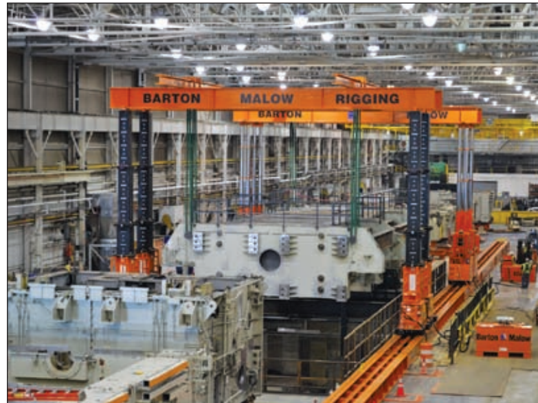
Bis zu 1.600 Tonnen wuppt der durchgehend teleskopierbare Power Tower von Lift Systems, auf 14 Metern noch 725 Tonnen
