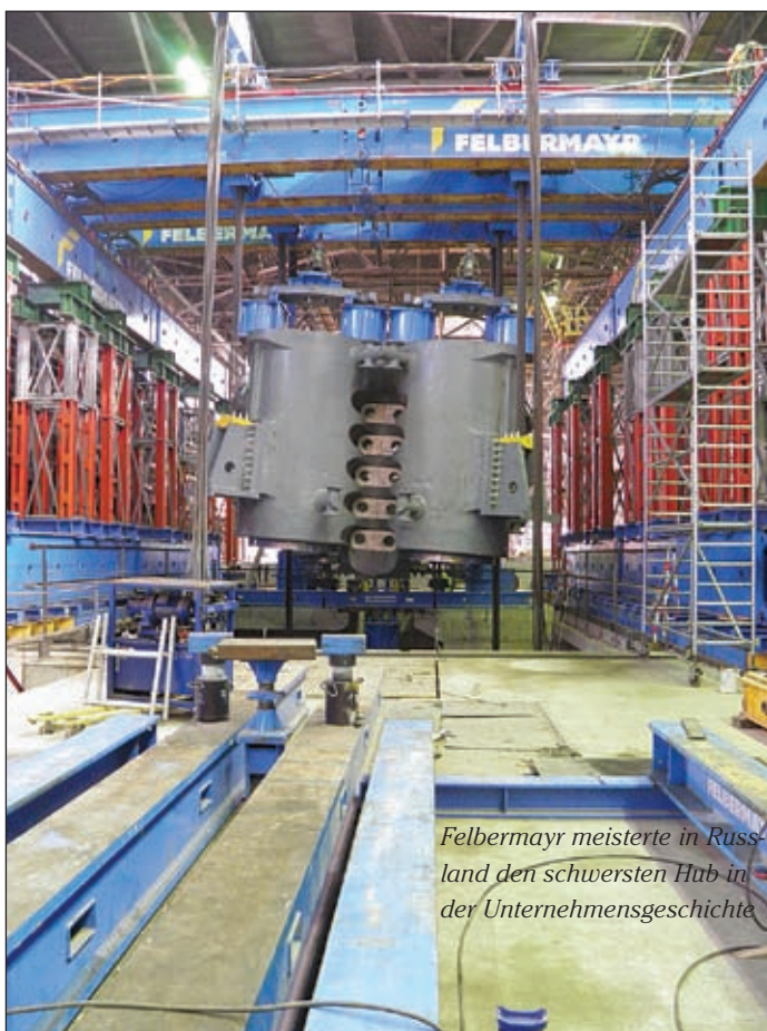
Greiners Hubgerüst GHS 3 hilft beim Verladen des 180 Tonnen schweren Kalzinators
