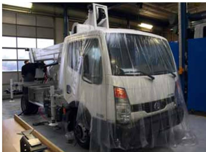
Die erste VTX-240 von Time aufgebaut auf einem Nissan-Chassis
