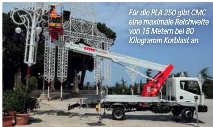
Für die PLA 250 gibt CMC eine maximale Reichweite von 15 Metern bei 80 Kilogramm Korblast an
