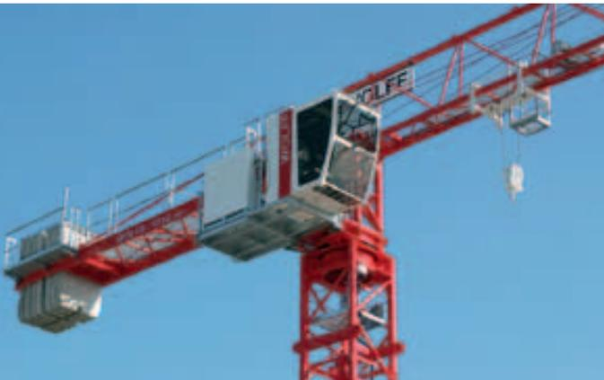
Den spitzenlosen Obendreher 5014 City hat Wolffkran in Bern enthüllt. Damit stellen sie ihrem 2006 eingeführten und bis dato einzigen City-Modell Wolff 4517 nun ein größeres Brudermodell an die Seite. Der 5014 City verfügt über eine Spitzentragfähigkeit von 1,4 Tonnen bei 50 Meter Ausladung und hebt maximal sechs Tonnen.
