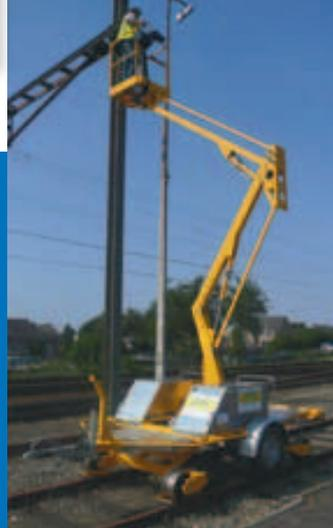
tet zehn Meter Arbeitshöhe, 120 Kilogramm Traglast und 3,5 Meter Reichweite. Mit dem Neuzugang wird Zitron Lüftungssysteme in Tunnelanlagen in ganz Belgien reinigen und warten. <<
