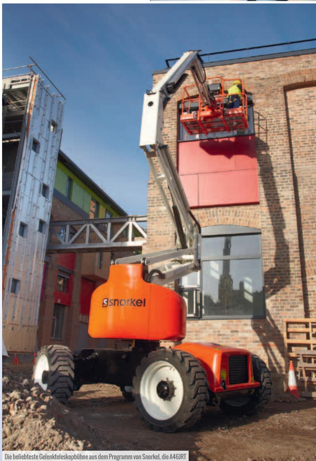
Die beliebteste Gelenkteleskopbühne aus dem Programm von Snorkel, die A46JRT
