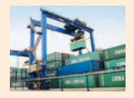
Im Dutzend in die Türkei: Terex Port Solutions hat die ersten zwölf von insgesamt 24 gummibereiften Containerstapelkranen (RTG) an das neue internationale Containerterminal Asyaport geliefert. Es liegt am Marmarameer in der Türkei. Die im chinesischen Xiamen gefertigten Geräte bieten eine Tragfähigkeit von 40 Tonnen und können mit einer Hubhöhe bis zu 21 Metern unter Spreader 1-über-6 Standardcontainer stapeln. Es handelt sich um die ersten Terex RTG in der Türkei überhaupt.
