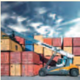
↑ Das erste Exemplar der neuen Reachstacker-Serie Pulser von **Liebherr** verrichtet seine Dienste im italienischen Ravenna. Der LRS 545 stapelt bis zu fünf Container in der ersten Reihe. Zudem hebt er 45 Tonnen in der ersten und 31 Tonnen in der zweiten Reihe. Das Gesamtgewicht des Geräts beträgt rund 70 Tonnen. Ausgestattet ist der LRS 545 mit einem 230 kW Vierzylinder-Dieselmotor der neuesten EU-Stufe IV / EPA Tier 4 final, einer Eigenentwicklung von Liebherr.
