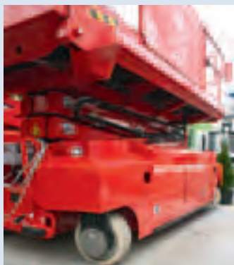
Eine neue Lenkung hat PB entwickelt. Damit kann auch quer gefahren werden
