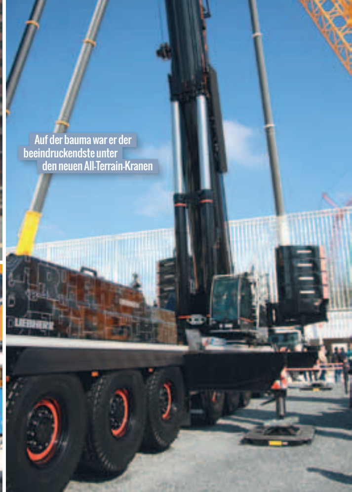
Ein Motor und 200 Millimeter schmäler als der Vorgänger: Groves GMK4100L-1
