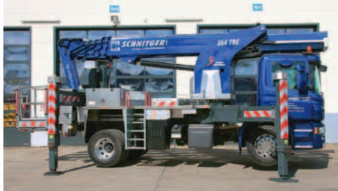
»» Eine neue France Elévateur des Typs 354 TBE hat die Firma W. Schnitger überreicht bekommen. Die besonderen Highlights der 35-Meter-Maschine sind laut Hersteller der teleskopierbare Korbarm, die kompakten Maße und eine Korblast von 400 Kilogramm.
