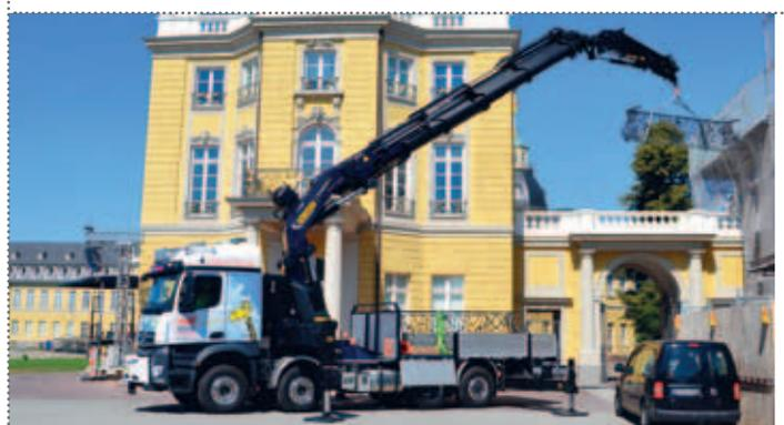
>> Lanz baut seinen Fuhrpark weiter aus. Neben etlichen Arbeitsbühnen gehört als Highlight der neue Ladekran von Palfinger dazu. Der für schwere Lasten und große Reichweiten ausgelegt PK 165.002 TEC 7 wurde mit Vollausrüstung geordert, also inklusive Fly-Jib und Seilwinde.
