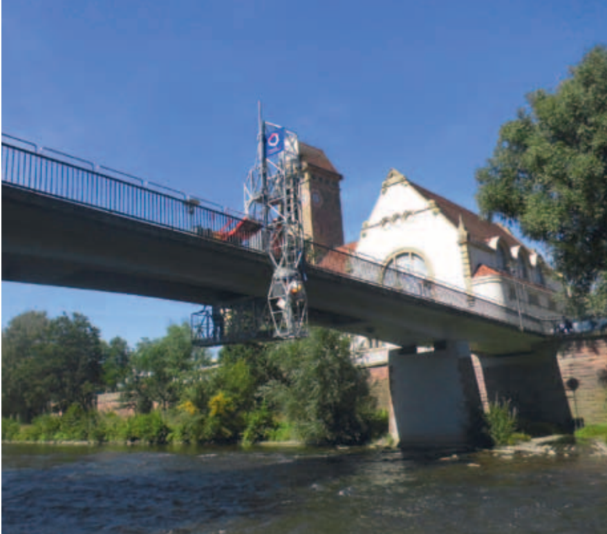
Das Raupengerät ABC 50 / C kann dank Raupenfahrwerk sein Gewicht gut verteilen und braucht wenig Platz
