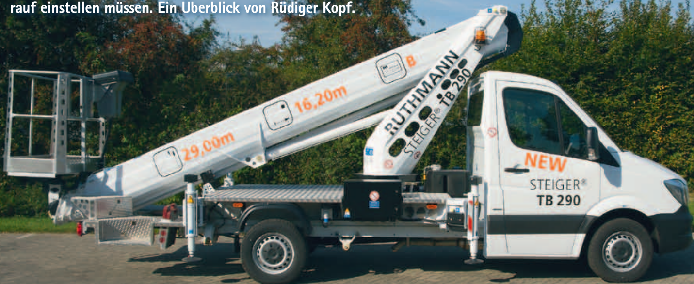
Rekord: Mit der TB290 erreicht Ruthmann 29 Meter Arbeitshöhe auf 3,5-Tonnen-Chassis
