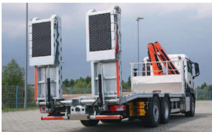
Seit kurzem ist im Großraum Luzern das neue „Baustellen-taxi“ der Heggli AG unterwegs. Der besonders niedrige Spezialaufbau auf einem MAN TGS 6x2-2 verfügt über einen Fassi F190 AXP und eine Plattformbrücke KTP 7.100, beide stammen von Notterkran. <<
