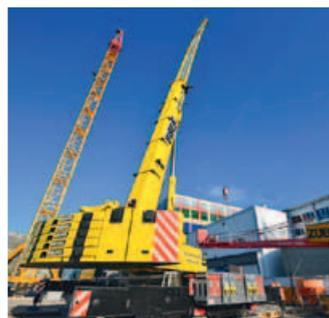
>> Die Eisele AG hat ihren Fuhrpark um einen GMK 6300L erweitert. Damit verfügt das Maintaler Unternehmen über knapp 40 Mobilkrane. Ausgerüstet mit einem 80 Meter langen Hauptausleger ist der Kran gut geeignet zum Aufbau großer Turmdrehkrane. Als erstes baute der GMK 6300L einen Wolff WK7532.12 im Zuge der Erweiterung des Frankfurter Messegeländes auf.
