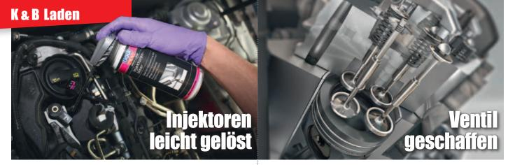
Injektoren sind für die Zerstäubung des Kraftstoffs das elementare Bauteil der Einspritzanlage – aber ein robustes. Aber Ablagerungen an den Düsenöffnungen können das feine Sprühmuster verändern. Oft ist eine Reinigung im eingebauten Zustand möglich. Wenn aber ein Ausbau unvermeidbar ist, kann dieser für den Monteur äußerst knifflig werden. Der Grund: ausgehärtete Verbrennungsrückstände. Diese lässt sich mit dem neuen Pro-Line Injek-
