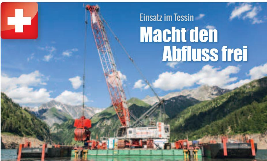
Im Tessin arbeitet gegenwärtig ein 130-Tonnen-Hydroseilbagger von Liebherr. Seine Aufgabe ist es, den Abfluss eines Stausees des Lago-di-Luzzone-Staudamms von abgelagerten Sedimenten zu befreien. Dafür ist die auf eine Barge montierte Maschine mit einem eigens konstruierten mechanischen Zweischalengreifer ausgestattet. Seit Anfang die-
