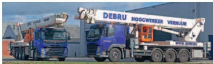
Debru legt sich zwei große LKW-Bühnen von Palfinger zu: eine WT610 und eine WT700, beide aufgebaut auf einem 4-Achs-Chassis von Volvo. Sie bieten 61
