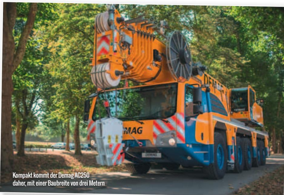
Kompakt kommt der Demag AC250 daher, mit einer Baubreite von drei Metern
