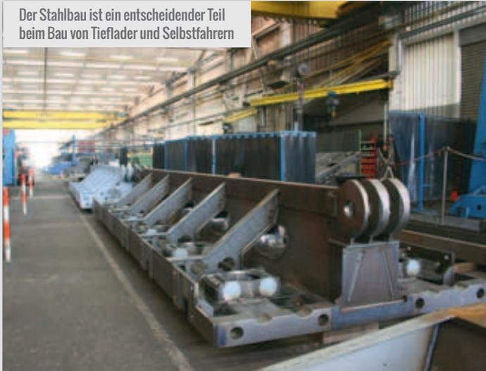
Der Stahlbau ist ein entscheidender Teil beim Bau von Tieflader und Selbstfahrern
