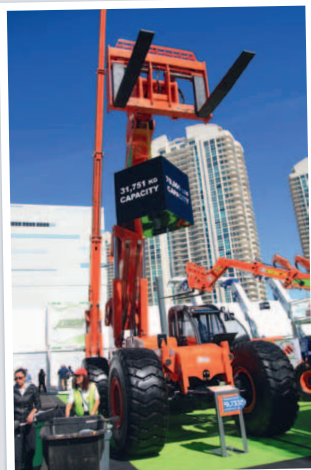
Schiere Größe: Xtremes Mega-Teleskopklader hebt 31,57 Tonnen
