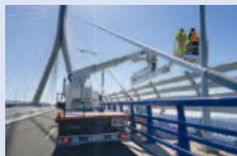
↑ **Barin** hat ein neues Brückenuntersichtgerät vom Typ AB 20/SL an die spanische Firma **Drace Infraestructuras** geliefert, die zum Baukonzern Dragados gehört. Die Maschine ermöglicht Arbeiten unterflur bis in 24,50 Meter Tiefe und erlaubt Reichweiten von 20 Meter unterhalb des Brückenbauwerks. Zudem kann sie Hindernisse, die 4,6 Meter hoch beziehungsweise 4,4 Meter breit sind, überwin-
