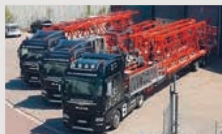
Auf drei LKW passt der gesamte Oberkran des Wotan 8035.20
