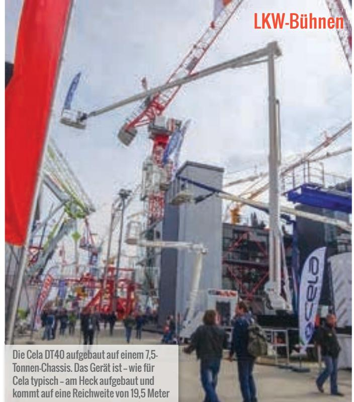
Die Cela DT40 aufgebaut auf einem 7,5-Tonnen-Chassis. Das Gerät ist – wie für Cela typisch – am Heck aufgebaut und kommt auf eine Reichweite von 19,5 Meter
