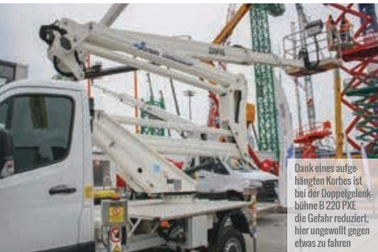
Dank eines aufgehängten Korbes ist bei der Doppelgelenkbühne B 220 PXE die Gefahr reduziert, hier ungewollt gegen etwas zu fahren
