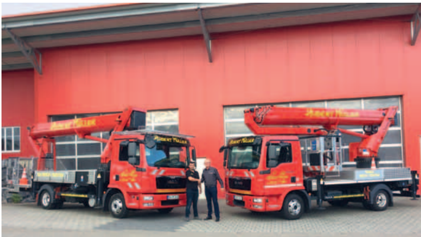
Hubert Müller aus Memmingerberg hat sich erstmals Ruthmann-Bühnen zugelegt: einen T330 und einen TU285. Die auf 7,5-Tonner aufgebauten Bühnen bieten 33 bzw. 28,5 Meter Arbeitshöhe und etwas mehr als 20 Meter Reichweite. <<
