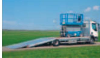
Zwei Neuheiten stehen parat: zum einen der Auffahraufleger LF18-82K mit einer abknickbaren Hinterseite und einem Auffahrwinkel von zehn Grad sowie elf
