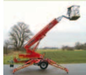
Die seit vier Jahren bei Rothlehner beheimatete Marke mit Anhängerbühnen zwischen 12 und 30 Metern punktet mit vielen Verbesserungen im Detail: Neu sind Steuergerät, Ladetechnik, ein stärkerer Rangierantrieb und die Option automatische Abstützung.
