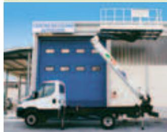
Solar heißt die neue LKW-Bühne mit einem großen 400-Kilo-Korb, die Comet in zwei Versionen und drei Optionen mit elf und 15 Metern Arbeitshöhe anbietet, wobei das kleinere Modell auf 3,5-Tonner und das größere auf einem 5-Tonnen-Chassis aufgebaut ist. Zudem schicken die Italiener ihre Mini-LKW-Bühnen mit bis zu 16 Metern Arbeitshöhe ins Rennen, montiert auf Piaggio Porter oder ähnlich kleinen Fahrzeugen.
