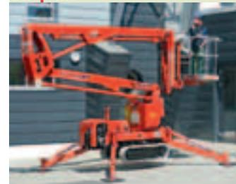
Der ungarische Fabrikant präsentiert seine neue 15-Meter-Raupenbühne TR15GT mit einer Arbeitshöhe von 15,60 Meter, einer seitlichen Reichweite von 7,50 Meter bei 220 Kilogramm Korblast. >>>
